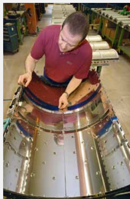
Montage von Bogenleitblechen für Druckmaschinen inkl. Funktionsprüfung
