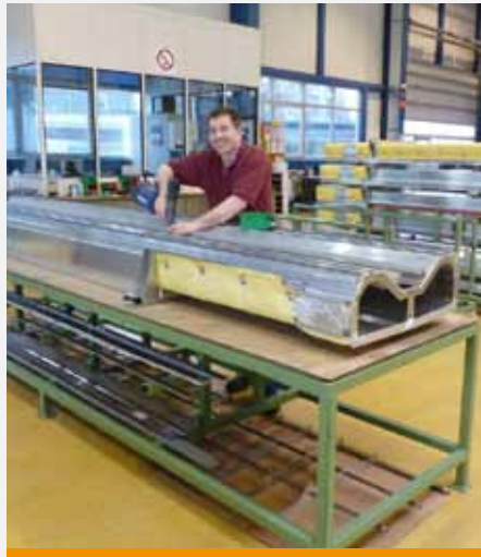
Montage und Bekleben von Luftkanälen
