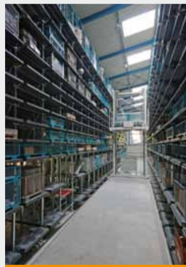
Neues Wabenlager mit RBG.
