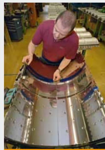
Prüfplatz für Bogenleitbleche (ag: Qualitätssicherung)
