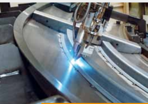
Laserschweißen der A-Säule eines Bahnzug Triebwagens
